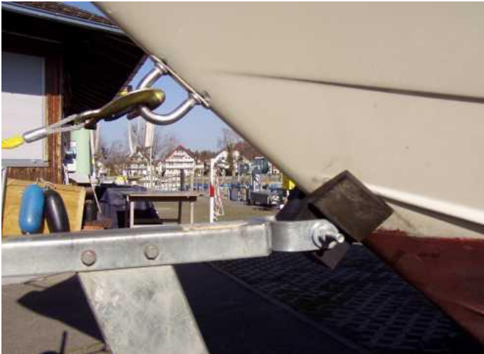
Aufgrund der massiven Bauweise offensichtlich ein leistungsfähiger Zurpunkt/Bug Öse.
